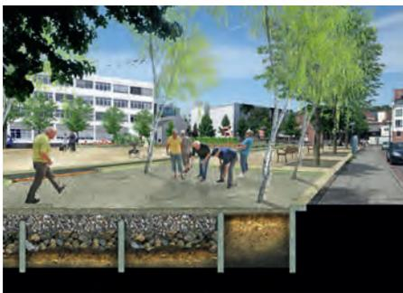
Temporäre Nutzung eines Stadtplatzes zum Wasserrückhalt bei Starkregen
